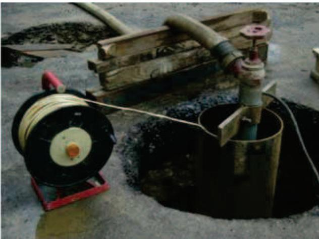
Misure piezometriche su pozzo singolo
